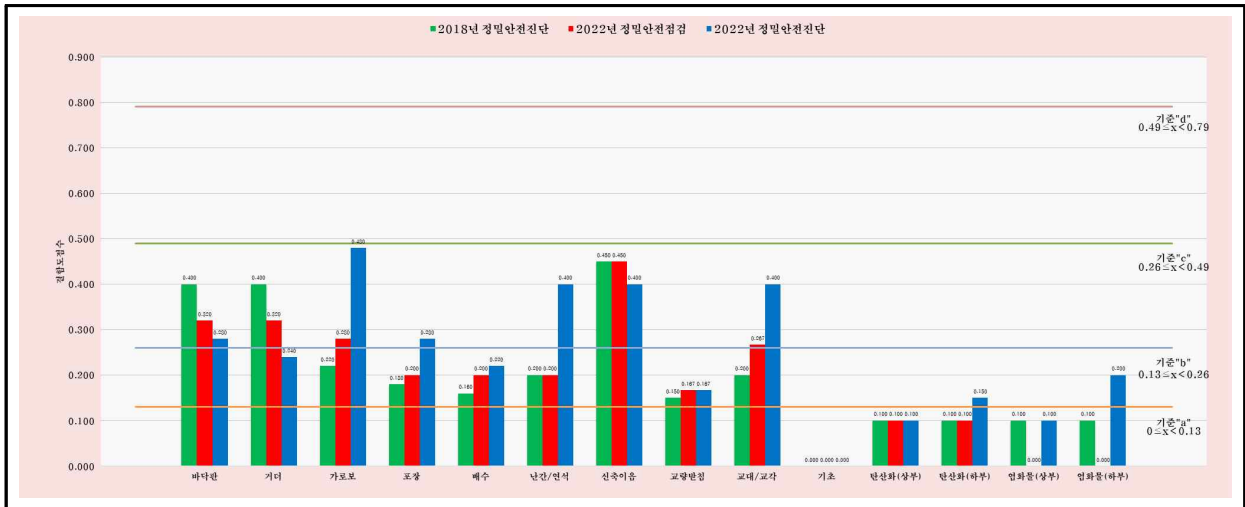
[그림 4.1] 탄천교(상행) 기 점검 및 진단 결과와의 상태평가 결함도지수 비교
